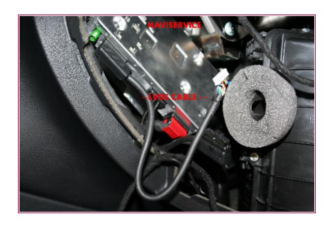
5. TO MMI CONTROLLER CONNECT LVDS CABLE FROM ADAPTER AND ALL FACTORY CONNECTORS.
