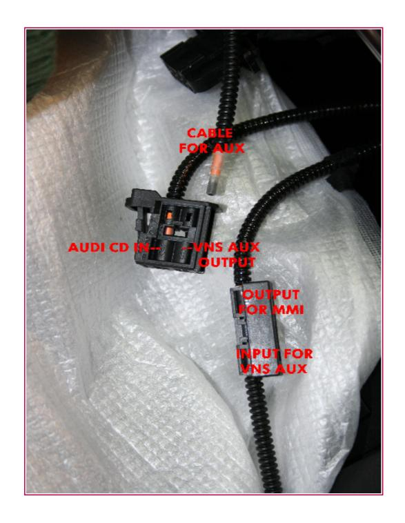
8.FROM OPTIC FIBER CONNECTOR OF CHANGER DISCONNECT
